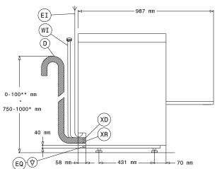
ΕI Electrical inlet (power) EO **Electrical Outlet**
